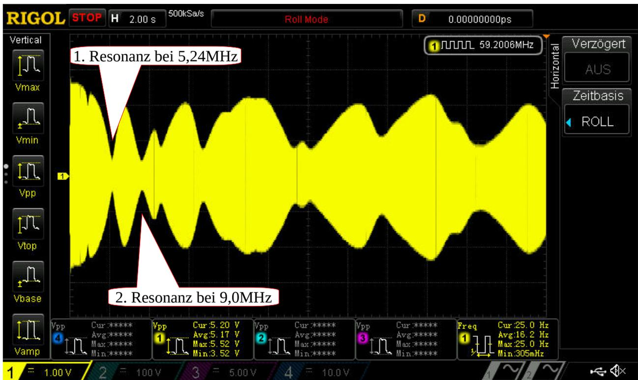
Frequenzdurchlauf / sweep von 0 - 60MHz
