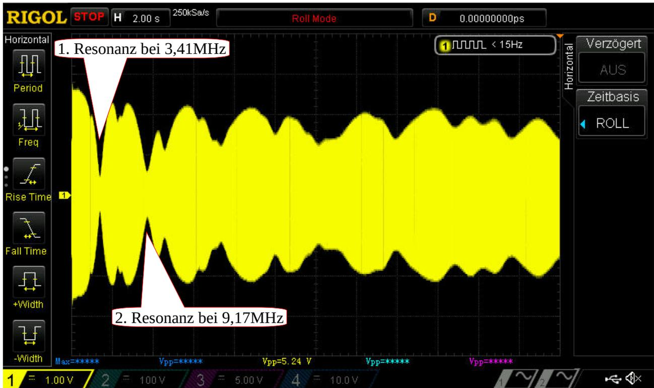
Frequenzdurchlauf / sweep von 0 - 60MHz
