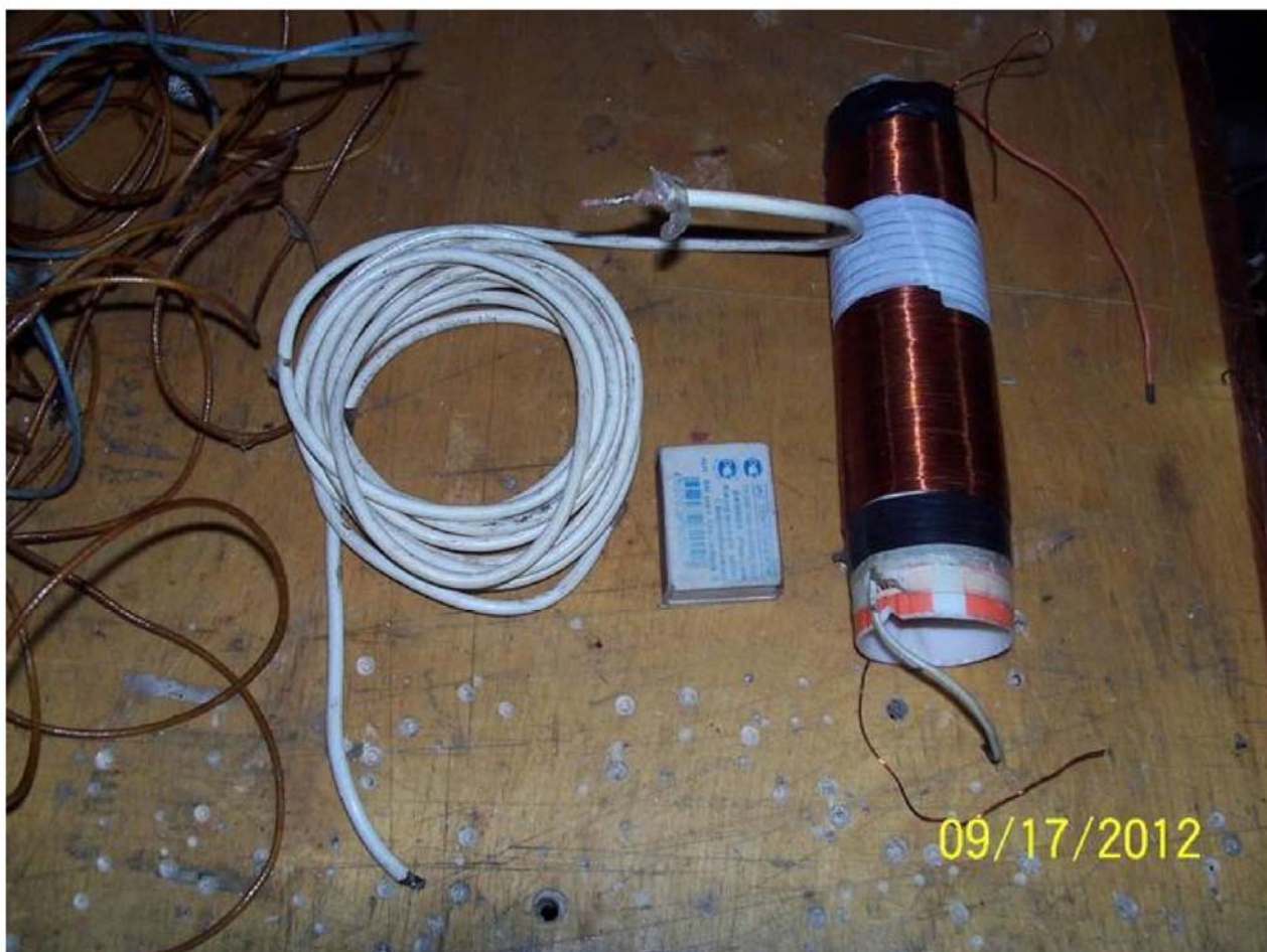
Фото9 Под коаксиалом 159 витков провода 0,85 мм.(фото 9,10)
